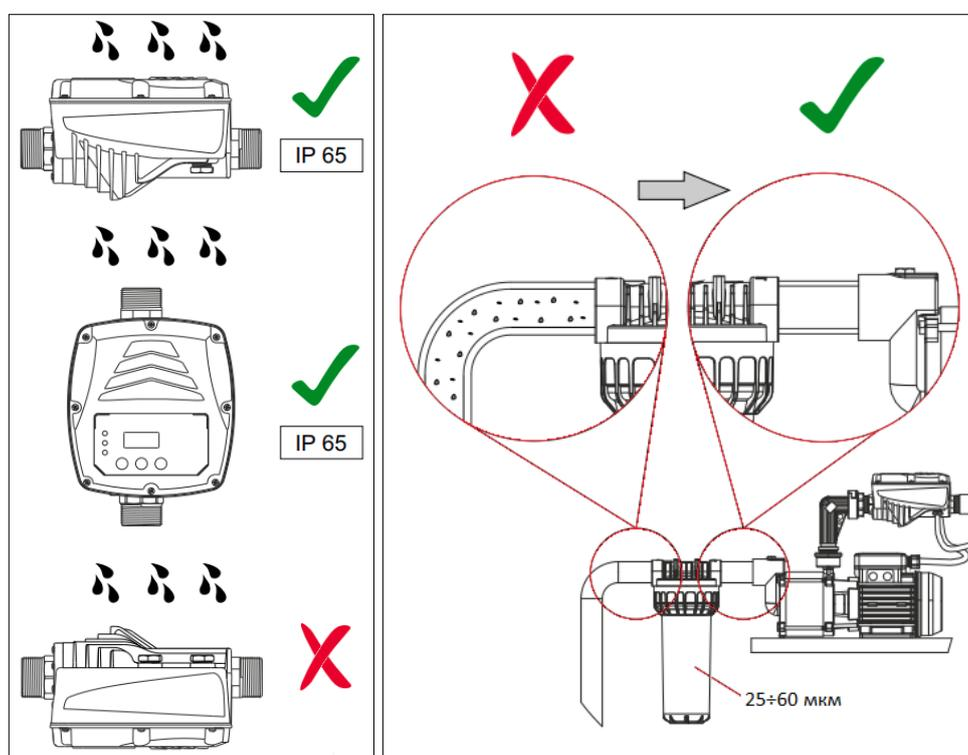
**Внимание!** Устройство BRIO-TOP устанавливается в систему с погружным или поверхностным насосом производительностью не менее 3,5 литр/мин.
