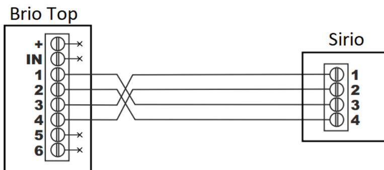
обычной работе разбор в воды в системе удовлетворяются насосом с инвертером Sirio, который всегда включается первым. Когда потребность в воде повышается настолько, что мощности одного насоса становится недостаточно, включается вспомогательный насос, работающий на постоянной скорости. Клеммы с 1 по 4 используются для соединения между двумя устройствами, а клеммы 5 и 6 предназначены для релейного выхода, используемого для сигнала тревоги.
